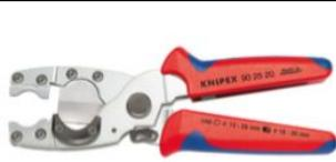
Tagliatubi per tubo multistrato con corpo in acciaio al cromo vanadio, bonificato temperato ad olio. Lama in acciaio speciale, temperato ad olio, intercambiabile. | 10 ÷ 32          |
