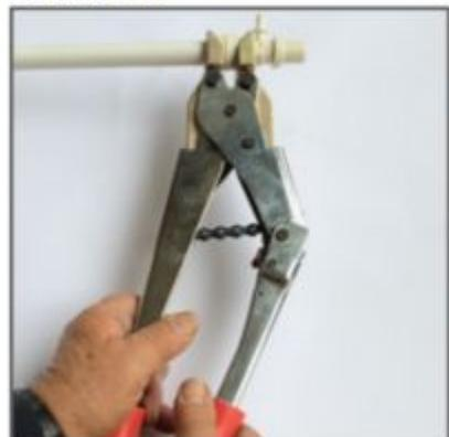
**12) quando la boccola giunge a fine corsa la giunzione è terminata**
