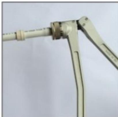
**9) inserire il raccordo nel tubo espanso**
